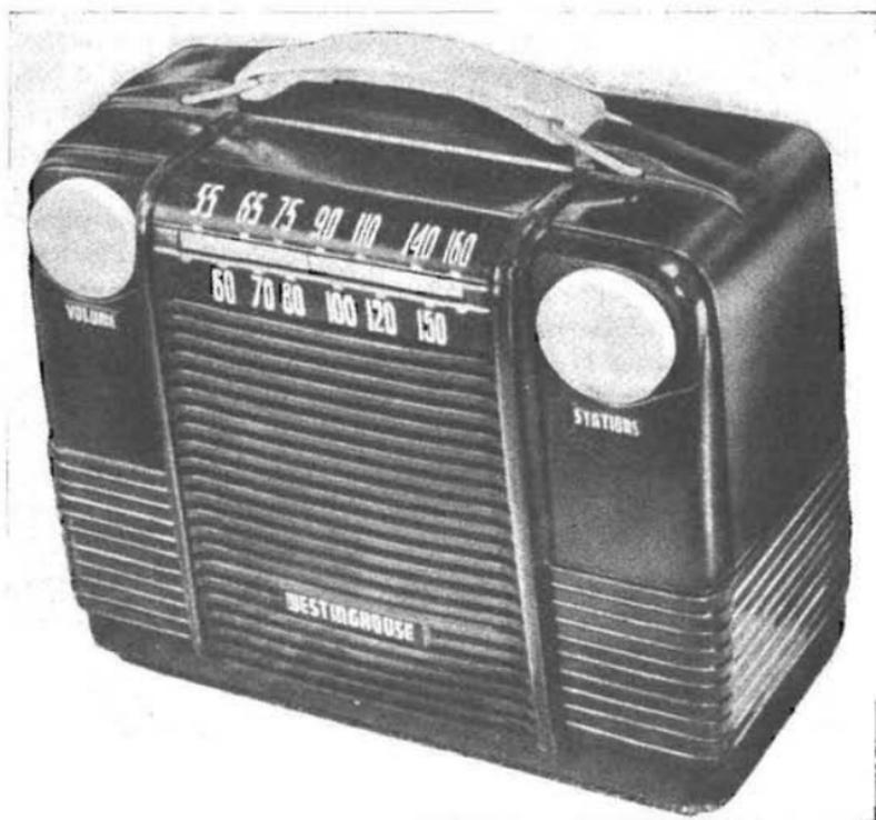
Fig. 9.13. - Tipico esempio di portatile pile-rete (a tre correnti), con rettificatore a selenio, di produzione americana. (Westinghouse mod. 185).
